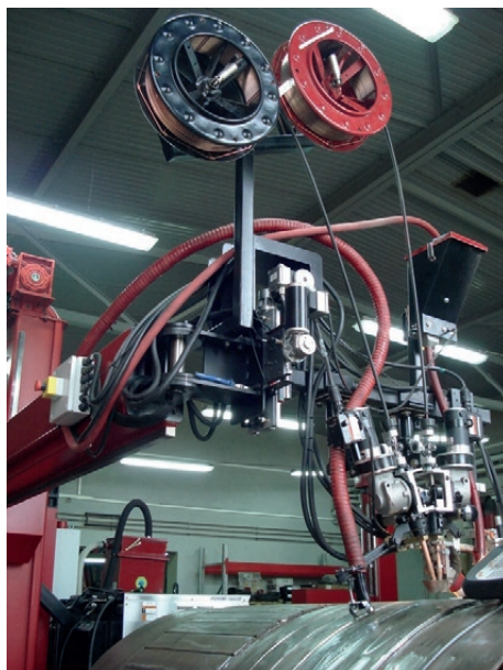
Сварка кольцевых швов
