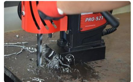
Сверление спиральными сверлами до 23 мм
