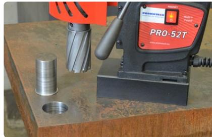
Сверление корончатыми сверлами 50 мм
