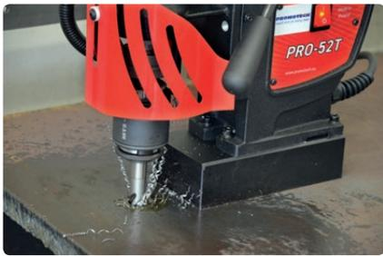
Нарезание резьбы в сквозных отверстиях до M20
