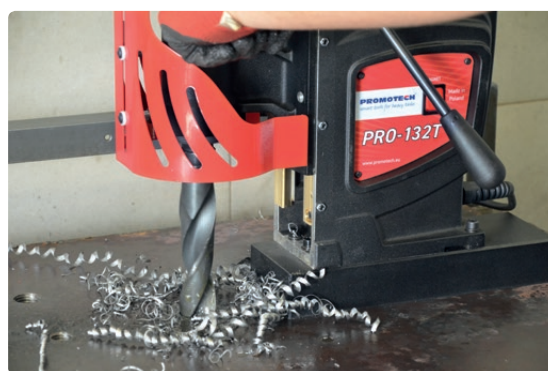
Сверление спиральными сверлами до 47 мм Ход штока до 260 мм
