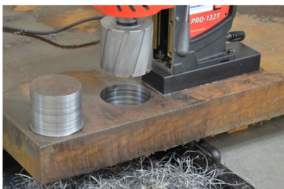
Сверление корончатыми сверлами диаметром до 130 мм на глубину до 100 мм
