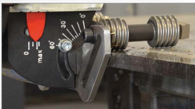
Плавная регулировка угла фаски 0-60°
