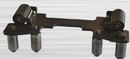
Приспособление для снятия фаски с закруглённых поверхностей
